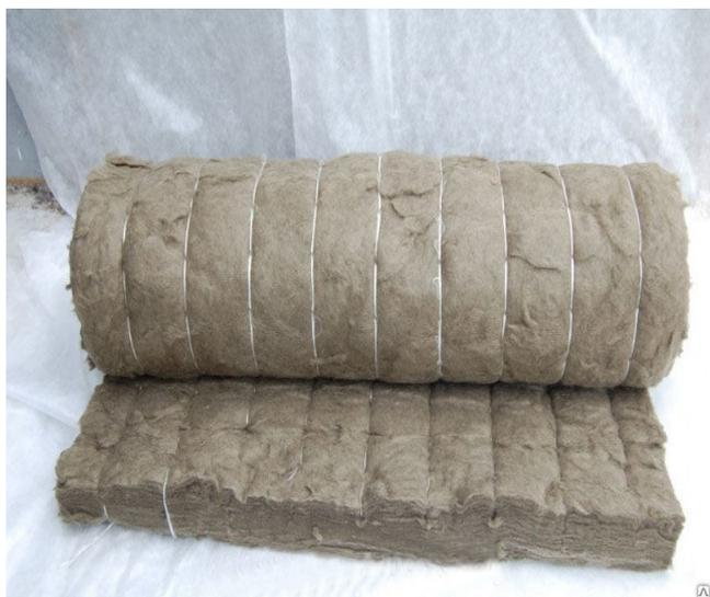
**ОПИСАНИЕ ПРОДУКТА:** Мат прошивной «МП - 75» - это негорючий звуко-, теплоизоляционный материал получаемый из расплава горной породы (природного камня) базальтовой группы, прошитый стеклоровингом.
